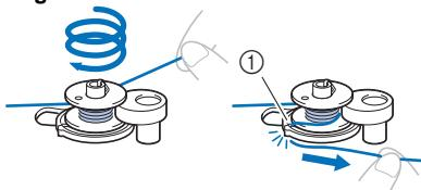
① Vodilica špulne (sa ugrađenim nožem za odsecanje)
